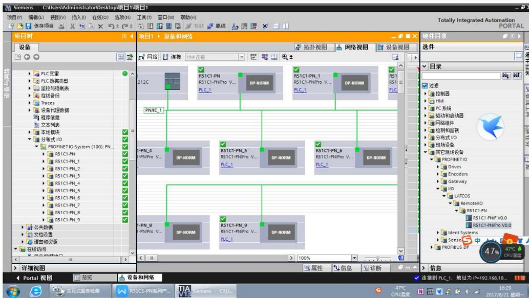
②下图为远程 IO 系统挂载为 11 个时的监控图（经测试通讯失败）
