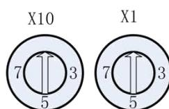
图 4 节点 ID 设置开关
