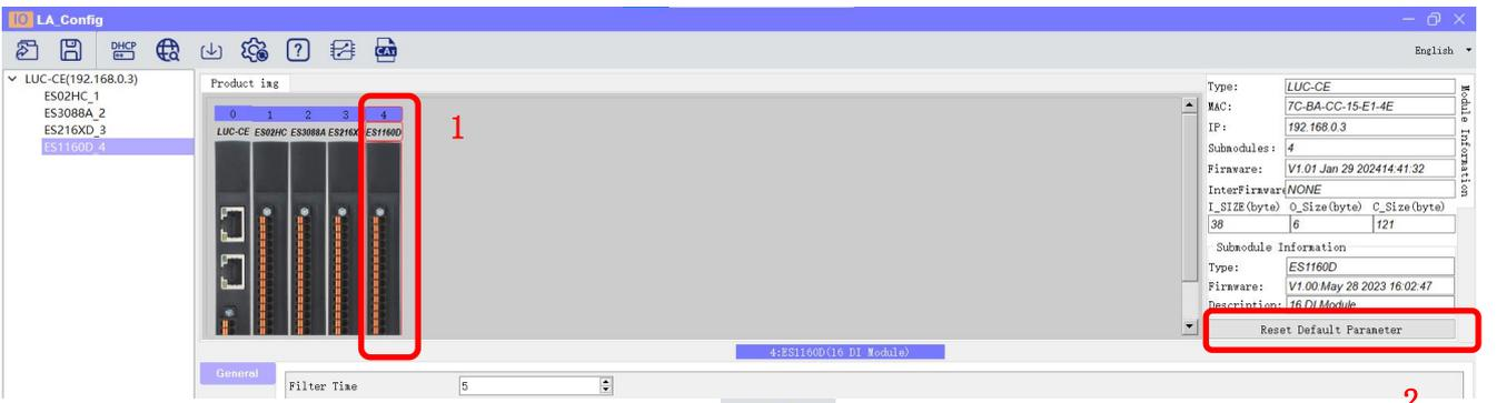
在参数设定区设定模块参数。设置完成之后点击
