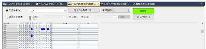
RWw-D600软元件起始地址为D600,监控表该地址的状态表示ES-04DMA的输出过程数据。 D600、D601通道一脉冲数,D602、D603通道一脉冲速度,D604、D605通道一控制字。
