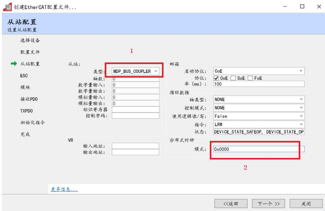
此页面的“数字量输入”、“数字量输出”、“模拟量输入”、“模拟量输出”这几项参数保持为 0 不可更改，否则可能会造成 PDO 数据区重叠，影响正常使用
