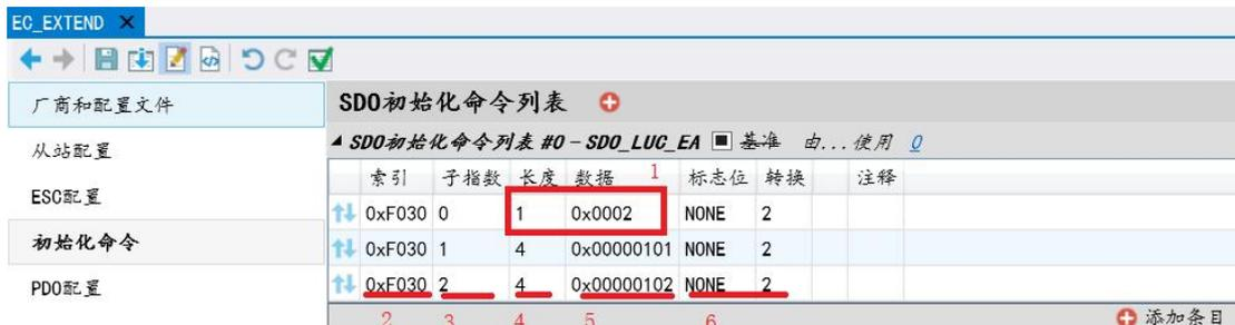
① “数据”一栏代表已安装的 IO 模块数量（不包含耦合器），在上述步骤中添加了 2 个 IO 模块所以数值为 2，但系统生成的数值为 10 进制需手动将其改为 16 进制；“长度”固定设置为 1 (byte)
