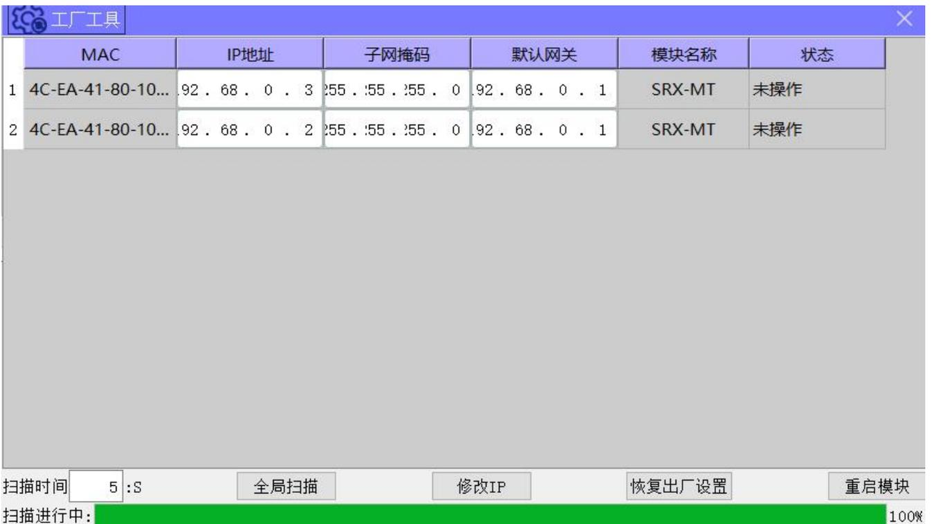
在表格中修改IP地址，完成修改后，点击“修改IP”将修改的IP下载到模块里面，看后面的状态栏显示分配成功即可。
