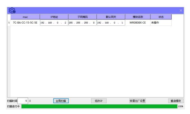
在表格中修改IP地址,完成修改后,点击"修改IP"将修改的IP下载到模块里面,看后面的状态栏显示分配成功即可。
