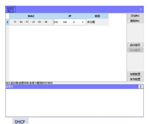
点击工具栏中的 按钮,打开DHCPService功能,单击"添加MAC"和"删除MAC"按钮来添加需要分配的模块的MAC码,以及填写相对应的IP地址。添加完成之后单击"启动服务"(如下图) 进入分配IP地址的过程,分配是否成功可以在后面的状态列中显示出来(如下图)
